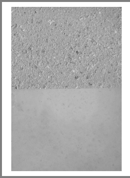
Normalbeton Grauzement glatt / gestrahlt
