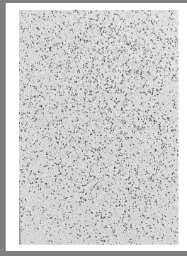
Exklusivbeton Carrara- u. Basaltzuschlag Weißzement gestrahlt
