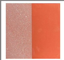
Normalbeton – Weißzement 8 % Rotpigment Gestrahlt / glatt
