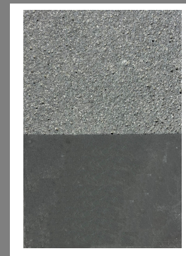
Exklusivbeton Basaltzuschlag Grauzement mit Anthrazitpigment glatt / gestrahlt
