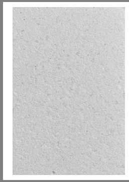
Exklusivbeton Carrarazuschlag Weißzement gestrahlt
