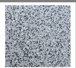
Normalbeton – Weißzement 8 % Gelbpigment Gestrahlt / glatt
