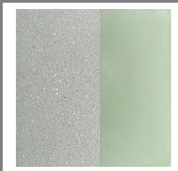
Normalbeton – Weißzement 8 % Rotpigment Gestrahlt / glatt
