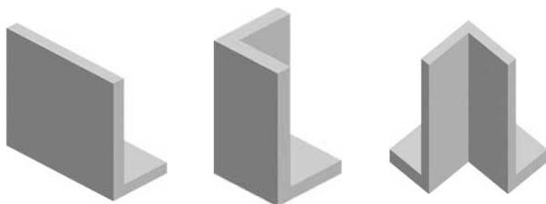
Das Versetzen der Mauerscheiben muss auf einer Frostschutztragschichte erfolgen. Bei kleinen Höhen genügt verdichteter Kiesuntergrund je höher die Mauerscheibe, desto höher wird die Belastung auf den Untergrund und die Fundierung muss demnach so ausgeführt sein, dass es dieser Druckbelastung standhält.
