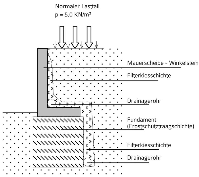
Entscheidend für die Haltbarkeit der Stützmauer, ist eine funktionierende Drainagierung. Anfallende Hangwässer müssen abgeleitet werden.
